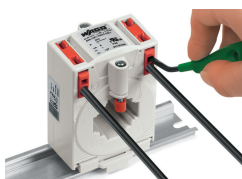
Terminação do condutor – atuação da chave de fenda paralela à entrada do condutor
